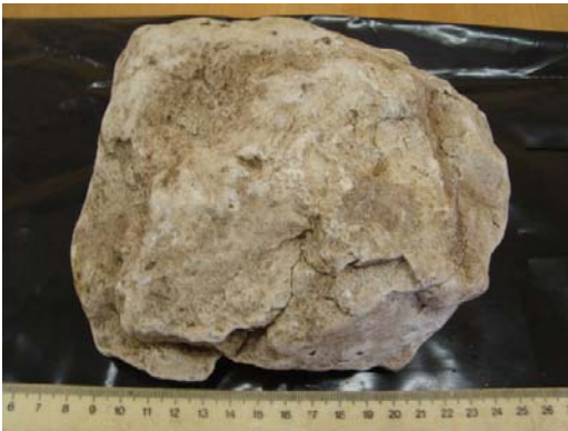
Fig. A1.1.12 Calcrete. \rho_d = 1\,876 \text{ kg m}^{-3} .
