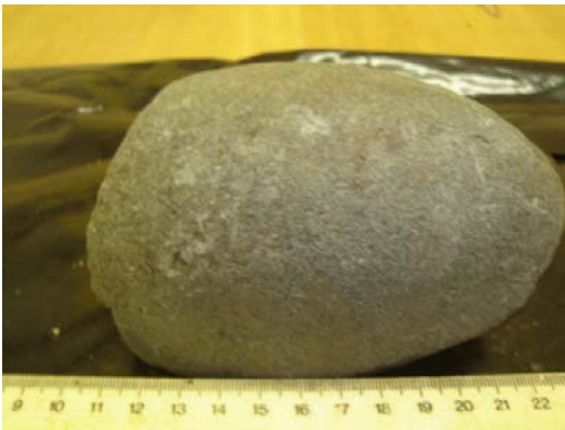
Fig. A1.1.8 Dolerite. \rho_d = 2\,910 \text{ kg m}^{-3} .
